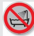
ISO 7010/P026 Verbot, dieses Gerät in der Badewanne, Dusche o. über mit Wasser gefülltem Waschbecken zu benutzen
