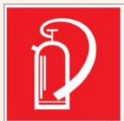
BGV A 8/F05 Feuerlöscher
