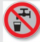
BGV A 8/P005 Kein Trinkwasser
