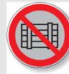
BGV A 8/P012 Abstellen oder Lagern verboten
