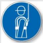
BGV A 8/M009 Auffanggurt anlegen
